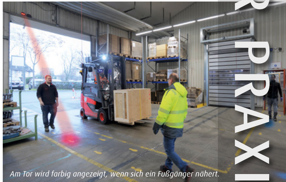
Truck Unit mit elektronischer Anzeige am Stapler.
