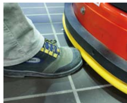
Detail: Fußschutzleiste trifft auf Schuh
