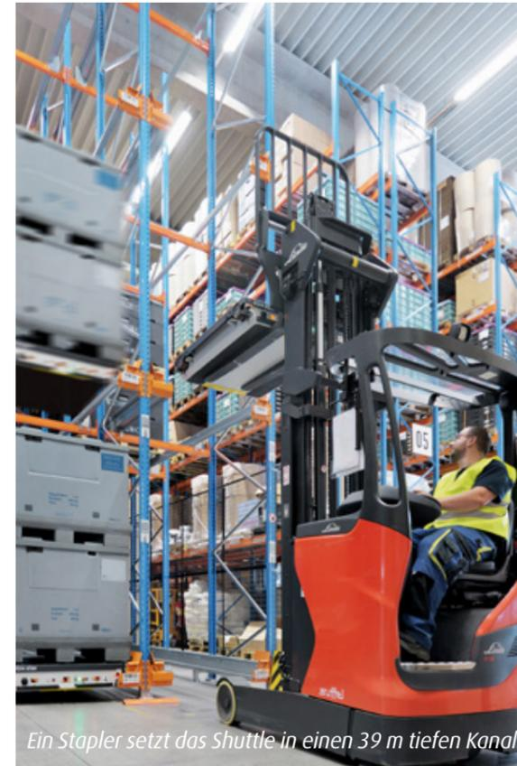
Ein Stapler setzt das Shuttle in einen 39 m tiefen Kanal.
