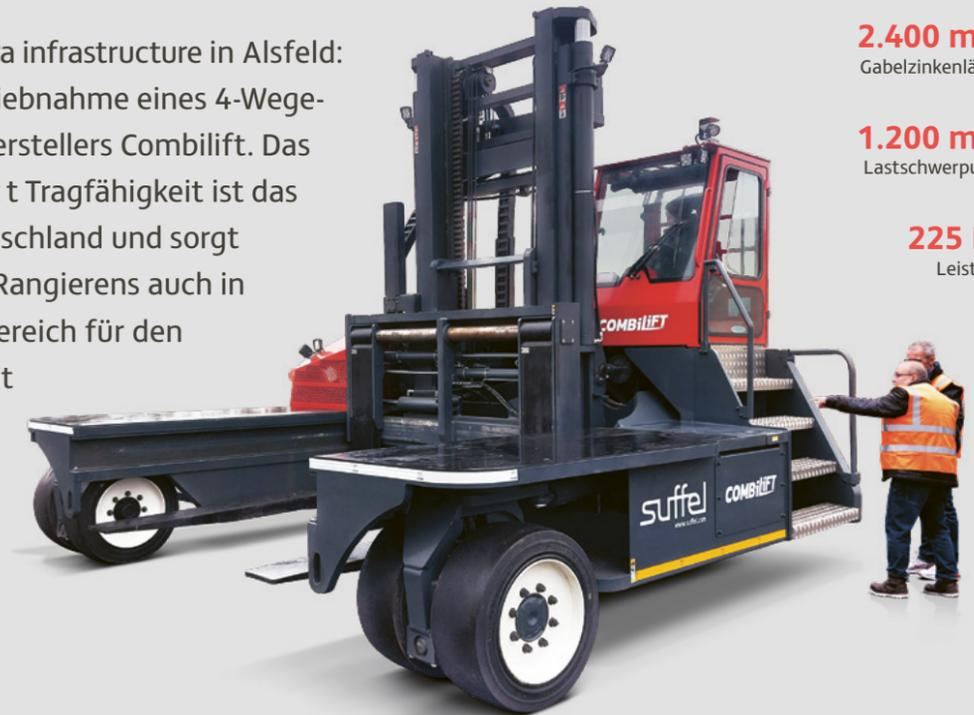
Die Anlieferung des teilmontierten Combilift C 22000 aus Irland war aufwändig. In Rotterdam eingeschifft ging es vier Nächte lang per Sonderschwertransport via Niederlande nach Hessen. Am Ziel in Alsfeld wurde der 4-Wege-Stapler per Autokran abgeladen und Mast, Gabelträger und Gabelzinken von den Suffel Fachleuten am Gerät montiert. Nach sieben Stunden war das spektakuläre Fahrzeug startklar und es folgte eine intensive Schulung der Bediener durch Suffel.
