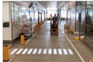
↑ Sichtbarer Bodenhinweis schützt vor Kollisionen an stark frequentierten Kreuzungen
