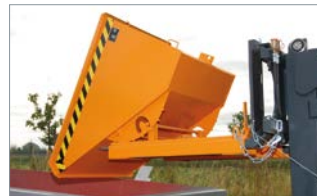
↑ Kippbehälter mit Stapleraufnahme beim Entleeren
