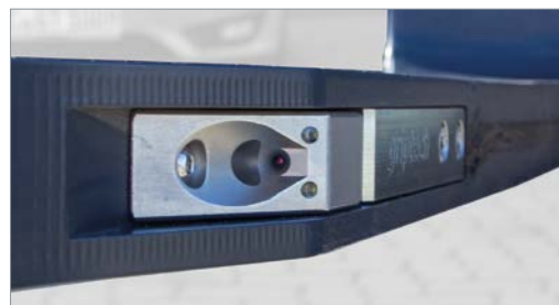
↑ Voll in die Kontur integrierte Kamera
