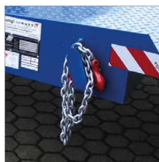
↑ Die beiden Sicherungsketten verhindern das Verrutschen
