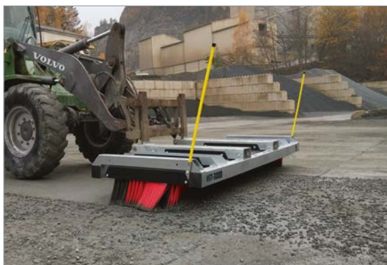
↑ Effiziente Grobreinigung: VST-3000 Kehrbesen im Baustelleneinsatz
