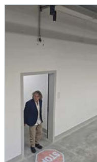
↑ Warnprojektion „STOP“ beim Türöffnen – schützt vor dem Betreten des Fahrwegs
