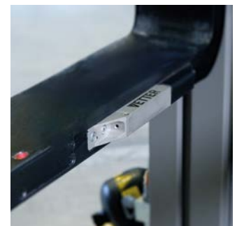
↑ Integrierte Gabelspitzenkamera – geschützt, präzise und perfekt im Blick
