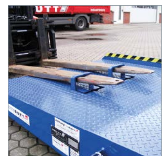
↑ Die Container-Überladebrücke kann mit dem Stapler transportiert werden
