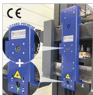
↑ LIZZARD Premium - durch das Laser- und Kamerasystem Lizzard haben Ihre Staplerfahrer jederzeit beste Kontrolle über den Gabelträger
