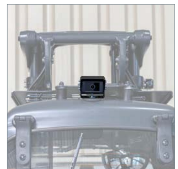
↑ Heckkamera für volle Rücksicht – robust, kompakt und wettergeschützt
