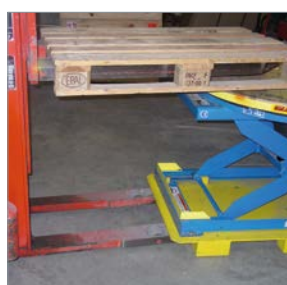
↑ Unterfahrvorrichtung für Lastrollen
