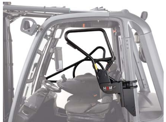
↑ Rückhaltesystem im Stapler für maximale Fahrersicherheit
