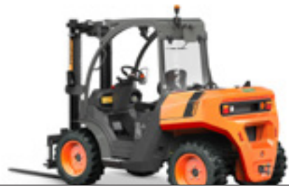
C151H 1500KG ANTRIEB 4x2 / 4x4 FULLGRIP® LEISTUNG 18,5KW BREITE 1.390MM ANTRIEB HYDROSTATISCH
