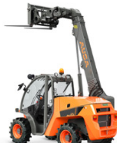
T235H 2300KG MAXIMALE HUBHÖHE 4.992MM LEISTUNG 32,8KW BREITE 1.590MM ANTRIEB HYDROSTATISCH
