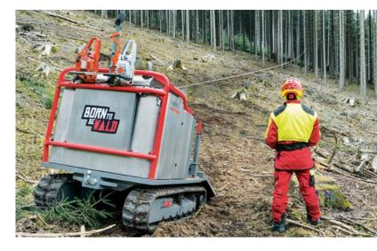
Die Seilwindenzugkraft von 4 t macht den SmartSkidder zu einem kleinen Kraftpaket.
