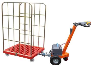
Mtrac mit Kupplung für Gitterrollwagen
