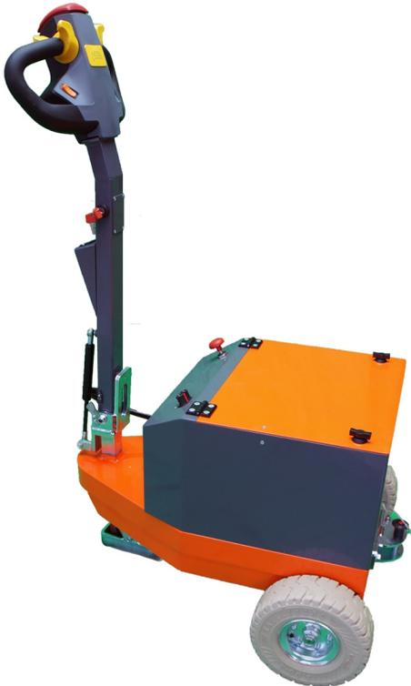
Abb.: helle, spurlose SE-Bereifung (optional)
