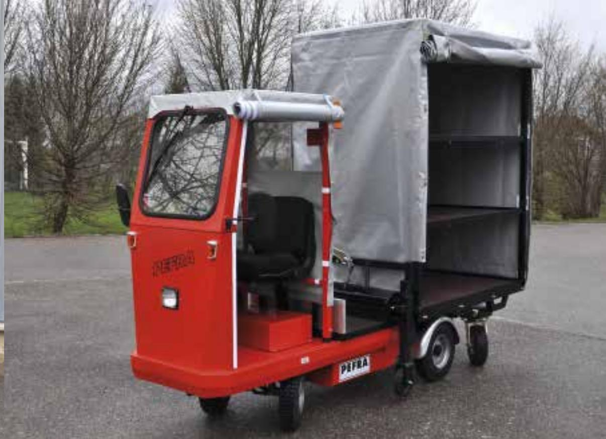
**Modell 610:** Kabinenaufbau für den universellen Einsatz
